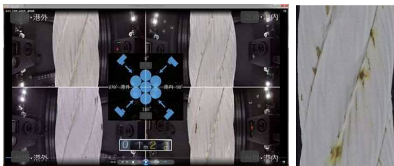
写真3 合成動画の画面と抽出した塗膜変状静止画
